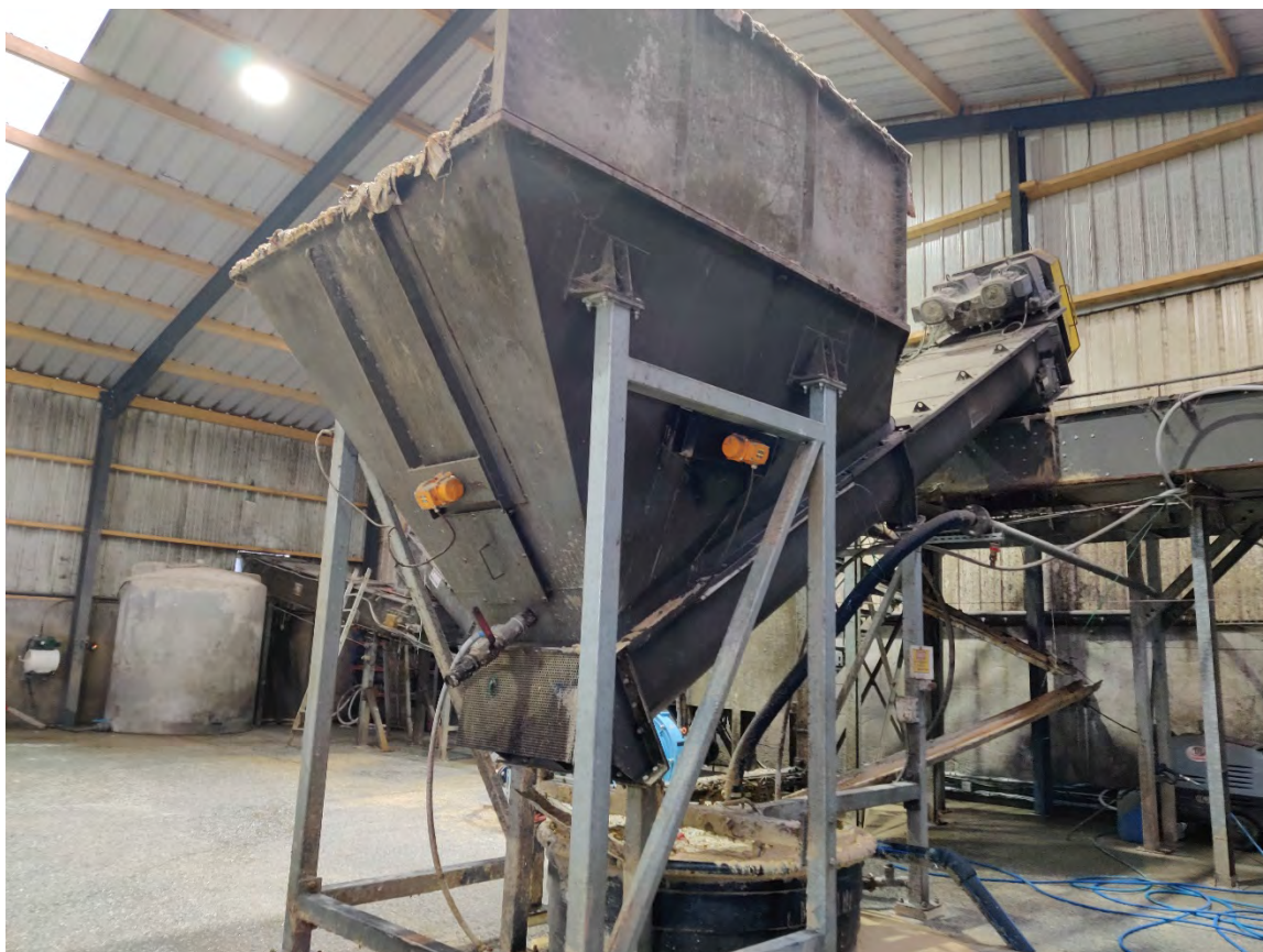
Trémie d'incorporation avec convoyeur à double vis
