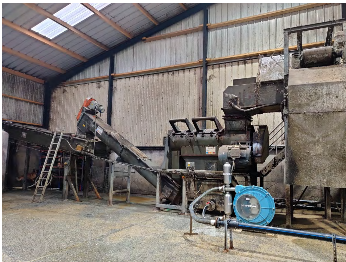
Vue d'ensemble du déconditionneur et du convoyeur d'évacuation des refus
