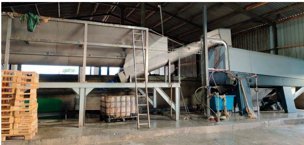
Vue d'ensemble de l'installation (de gauche à droite : trémie d'incorporation, déconditionneur)
