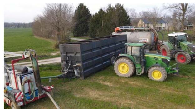
Pompe reliée à la rampe d'épandage, caisson de stockage ravitaillé par des tonnes à lisier
