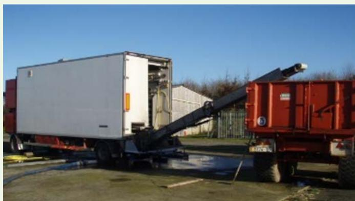
Décanteuse-centrifuge mobile sur chassis mobile, le refus solide sera composté avant d'être exporté tandis que la fraction liquide est envoyée dans une autre fosse de stockage.
