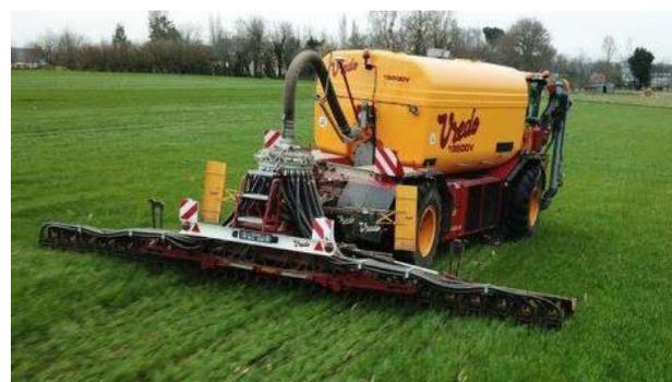
*Automoteur de l'Intercuma des 3 rivières (Pacé, 35) : Vredo de 19,5 m<sup>3</sup>, 450 chevaux, roulant en crabe, équipé de télégonflage et disposant d'un enfouisseur de 9 m de large (possibilité d'enfouisseur à dents de 6,70 m).*
