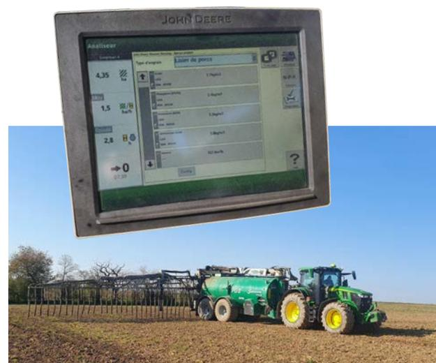
Tonne à lisier équipée d'un pendillard et console d'affichage de la composition du lisier épandu analysé par infrarouge
